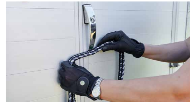
Kein Verfangen des Stricks durch anliegende Türgriffe.
