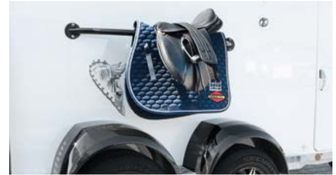
Praktische Ablagemöglichkeit durch einen Ablagebügel für Sattel und Schabracke (seitlich am Anhänger).
