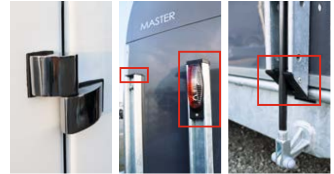
Keine scharfen Kanten und Ecken durch abgerundete Scharniere und Kunststoffabdeckungen an den Stahlprofilstreben und an den Enden der Heckstreben.
